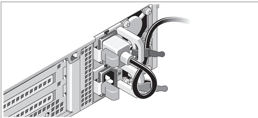
Faites une boucle avec le câble d'alimentation comme indiqué dans l'illustration, puis fixez-le à l'aide de la sangle fournie. Branchez ensuite l'autre extrémité du câble d'alimentation sur une prise secteur mise à la terre ou sur une source d'alimentation autonome (telle qu'un onduleur ou une unité de distribution de l'alimentation).
