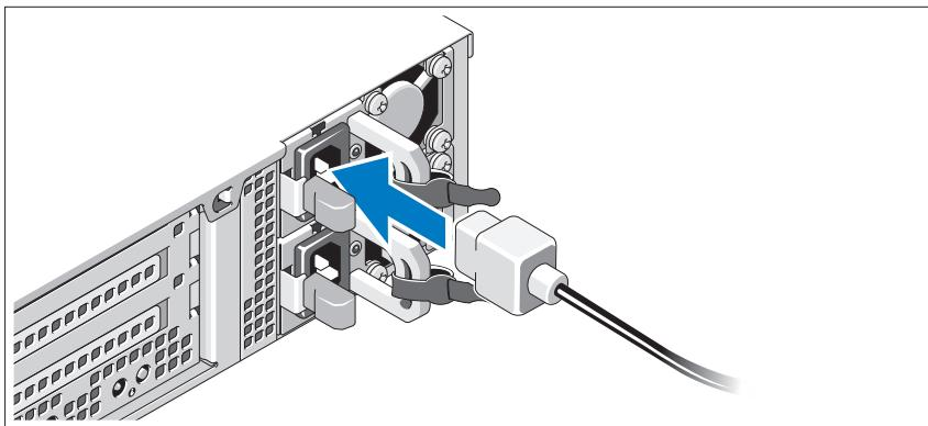
Conecte o(s) cabo(s) de alimentação ao sistema e, se for usado um monitor, conecte o cabo de alimentação do monitor.
