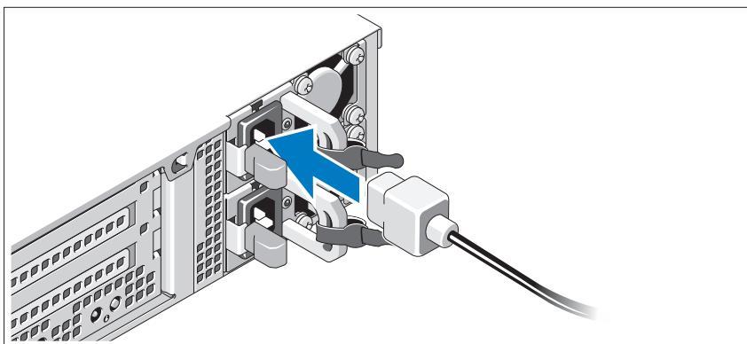
Connectez le ou les câbles d'alimentation au système et, si vous utilisez un moniteur, connectez son câble d'alimentation à celui-ci.
